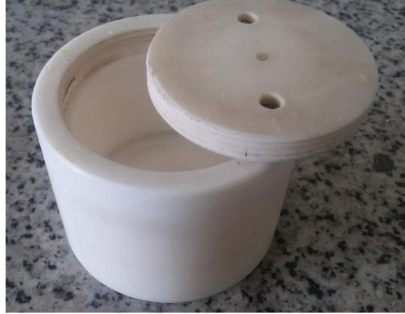
شکل ۳- مخزن داخلی راکتور از جنس تفلون
